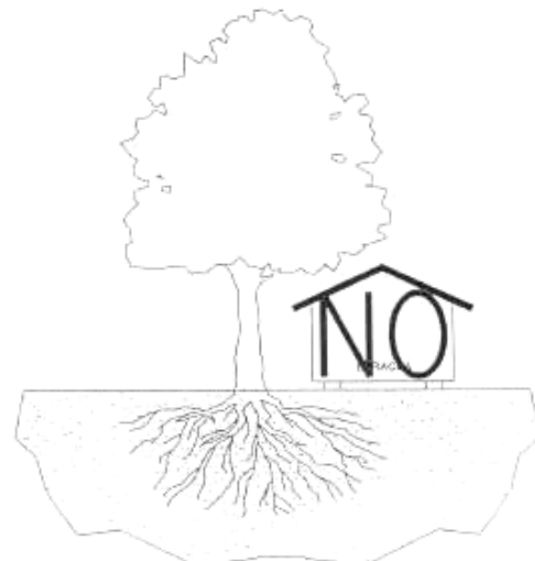
Fig. 4 Accorgimenti per l'innalzamento della quota di terreno nelle aree di pertinenza delle alberature. La ricarica di terreno nelle aree di pertinenza degli alberi è vietata.
